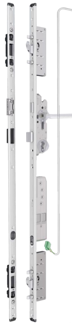
Cod. D6005 Serratura di sicurezza motorizzata a sette punti di chiusura con una mandata, due ganci e quattro punzoni.
